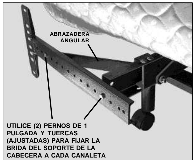
FIGURA 8: Instalación de la brida del soporte de la cabecera (fije una brida a cada una de las canaletas del soporte de la cabecera).
