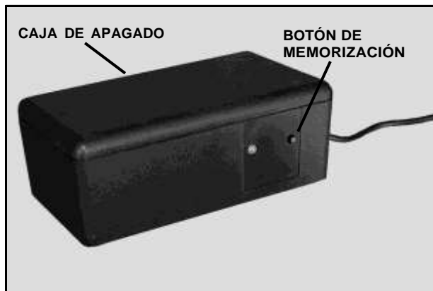
FIGURA 11: Unidad de recepción: caja de unión.
